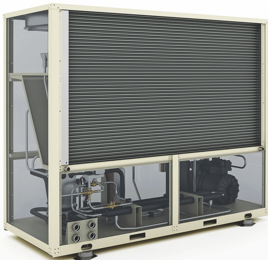
Fig. 4 - Pompa di calore compatta a CO 2 progettata per produrre acqua calda in applicazioni commerciali e industriali. L'acqua viene riscaldata in un solo passaggio dalla temperatura di rete fino anche a 90 °C, rendendo possibile lo stoccaggio in serbatoi d'acqua progettati per la stratificazione. Un controllore consente un funzionamento continuo per ogni condizione climatica (Enex).
