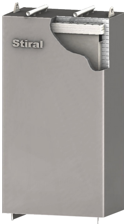
Fig. 9 - Recuperatore di calore BatTherm realizzato con materiali a cambiamento di fase. Il serbatoio rettangolare in acciaio inox accumula il calore di scarto prevalentemente dai processi industriali tra i 130 - 180 °C e lo rilascia quando richiesto attraverso il cambiamento di fase tra i 60-110 °C (Stiral).
